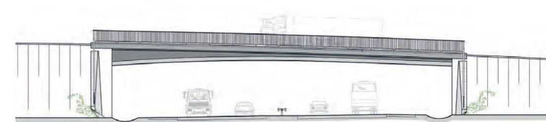
Brücke wird fast komplett seitlich neben dem Bestandsbauwerk hergestellt und dann quer an die Stelle der alten Brücke verschoben. Sie besteht zum großen Teil aus Fertigteilen.
